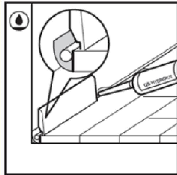
O Hydrokit Quick-Step é um silicone transparente que proporciona um acabamento impermeável e invisível para rodapés, perfis, etc.
