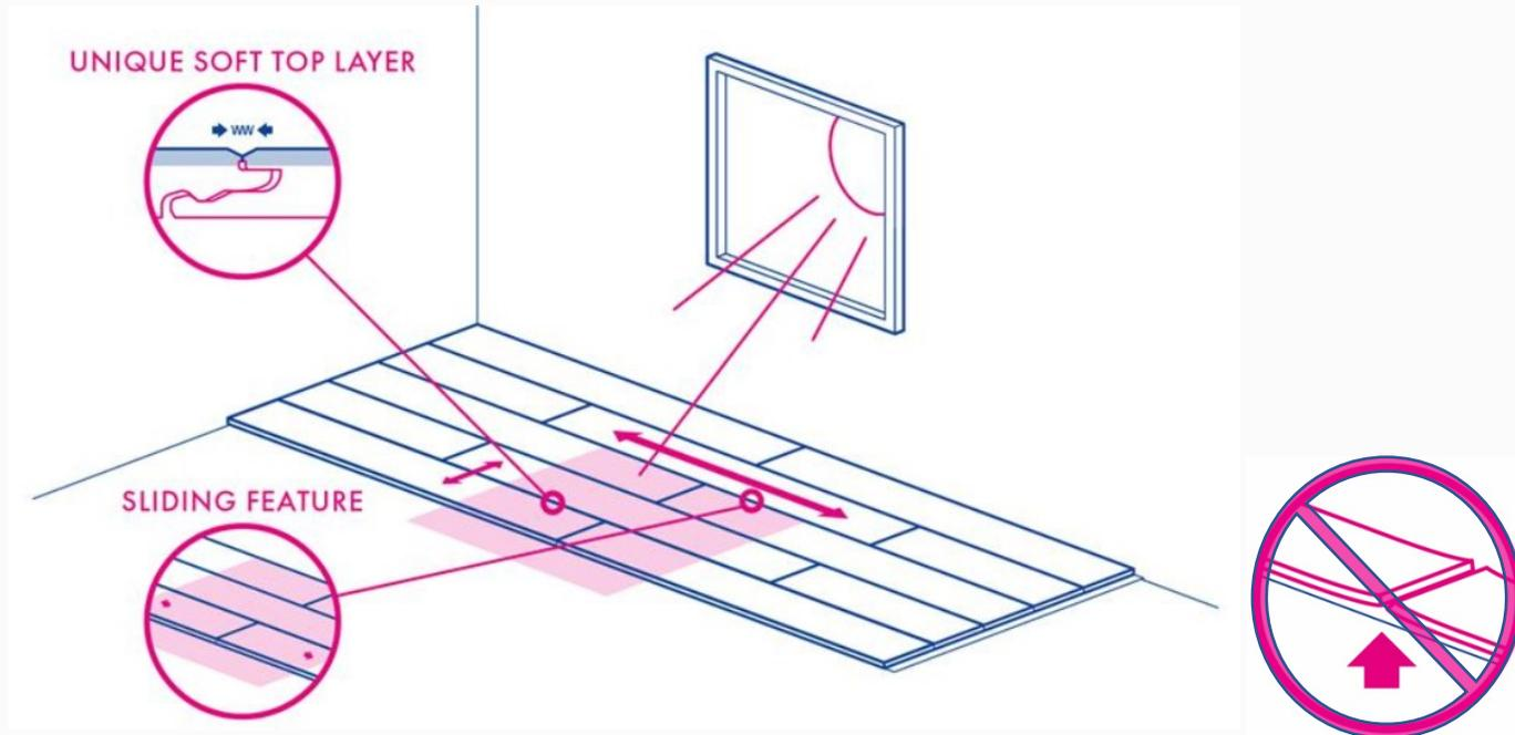
(\* *Cupping* é o levantamento do piso onde a temperatura em pontos muito locais é mais alta (chamados “hotspots”) do que a temperatura média do piso.
